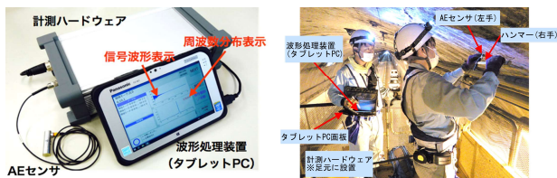
(a) 使用機器 (b) 打音検査状況
