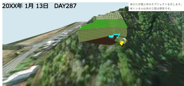
図 11 4Dモデル(起点側長大切土施工)
