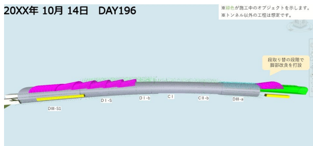
図 10 4Dモデル(先進導坑掘削)
