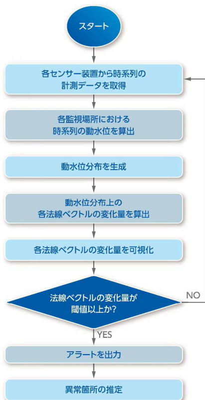
図-1 漏水検知フロー図
