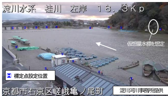
図-9 CCTV の観測画角
