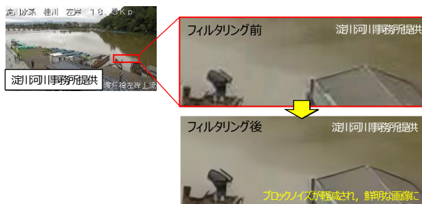
図-15 フィルタリング処理によるブロックノイズの軽減
