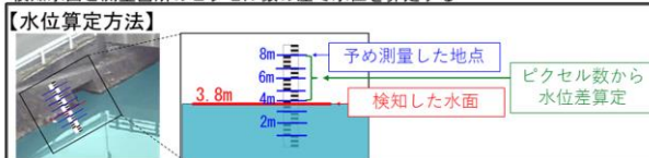
図-10 水面検知による水位算定手法の概要
