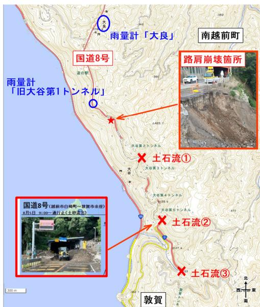
図-1 国道 8 号 被災概要<sup>3)</sup>
